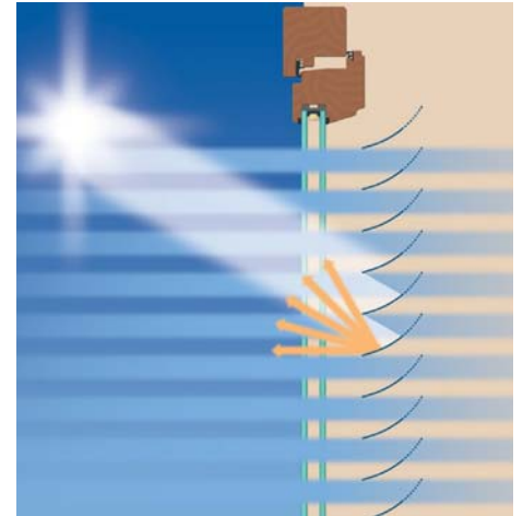
Reflexión de la radiación solar directa, transmisión de la luz diurna difusa, la combinación ideal de protección antideslumbrante sin perder el contacto con el exterior
